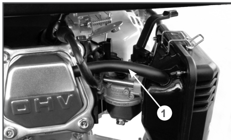
Рис. 15 Трубка системы вентиляции картера
